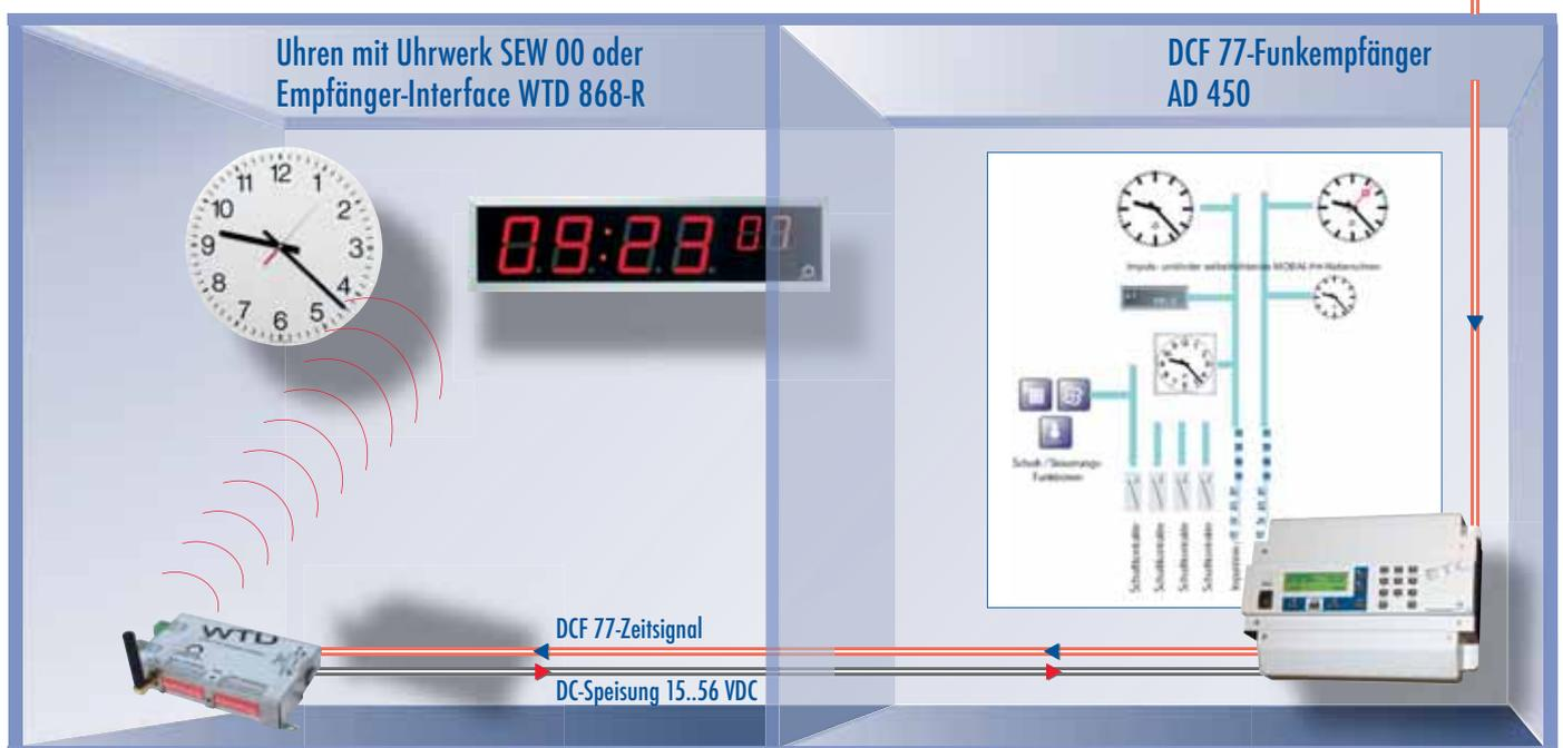
Ansteuerung des Sender-Moduls durch klassische Hauptuhr via DCF 77 und DC-Speisung ab Hauptuhr
